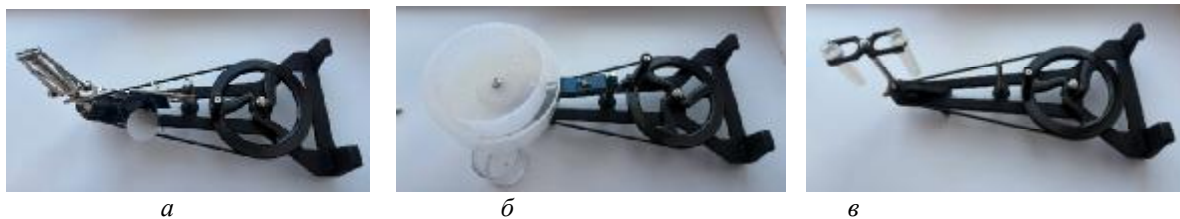
Рисунок 1. Приводная вращающаяся центрифуга (а - в демонстрационном положении с измерительным устройством, б - с установленным вращающимся барабаном, в - в положении держателя пробирок)
