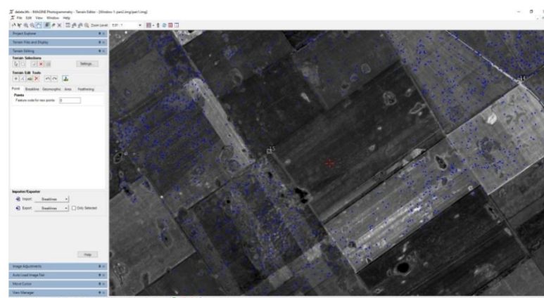
Рисунок 3 – Редактирование ЦММ в стереорежиме
