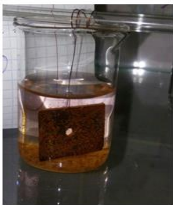
Рис. 2. Водяная нефтяная система с водопроводной водой
