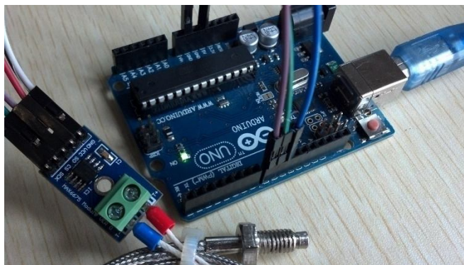
1 - Сурет - Сандық өлшеу кешені және болаттың меншікті жылусыйымдылығын анықтауға арналған зертханалық жұмысқа қажетті құрал-жабдықтар
