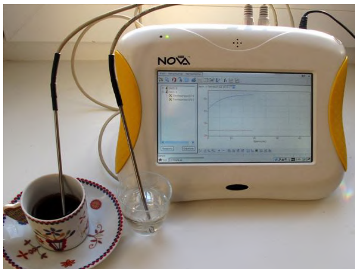
2 – Сурет – Nova шағын компьютерімен қайнаған кофе мен салқын су температурасын анықтау
